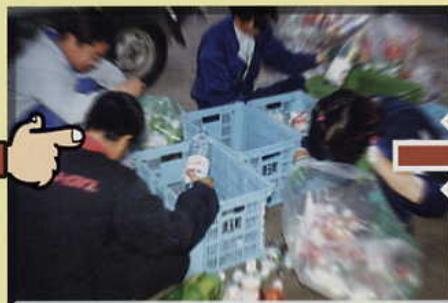
▶ **手選別キャップ取り** リサイクルできるペットボトルと、できないペットボトルを手で選別しキャップを外します。右の写真はリサイクルできないものです。
